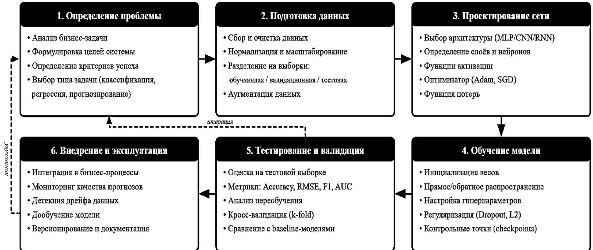
Рисунок 1.6 – Основные этапы разработки и внедрения автоматизированной системы принятия управленческих решений с использованием нейронных сетей (составлено автором на основе: [4])
