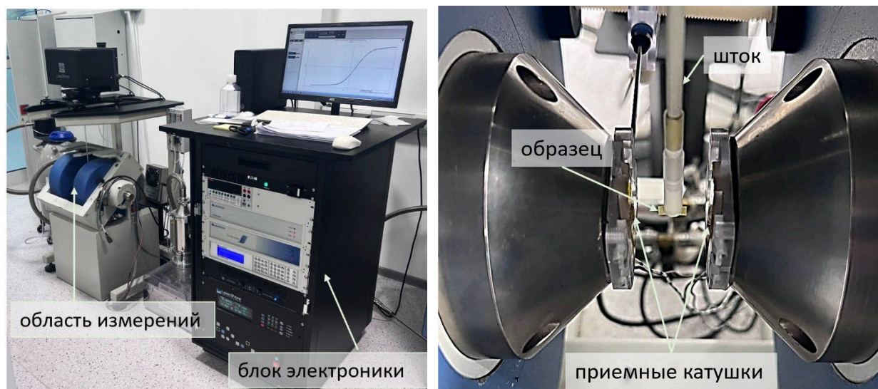
Рисунок 11 – Фото вибрационного магнитометра в БФУ им. И. Канта (слева) и вид рабочей области VSM (справа)
