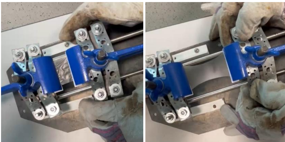
Рисунок 37. Фотография растяжной машины с композитом ПВДФ/ \text{CoFe}_2\text{O}_4 @ОАм до растяжения (слева) и после растяжения (справа).
