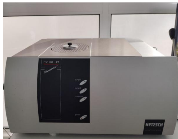
Рисунок 13. Схематическое изображение дифференциального сканирующего калориметра [74] (слева) и его фотография (справа).
