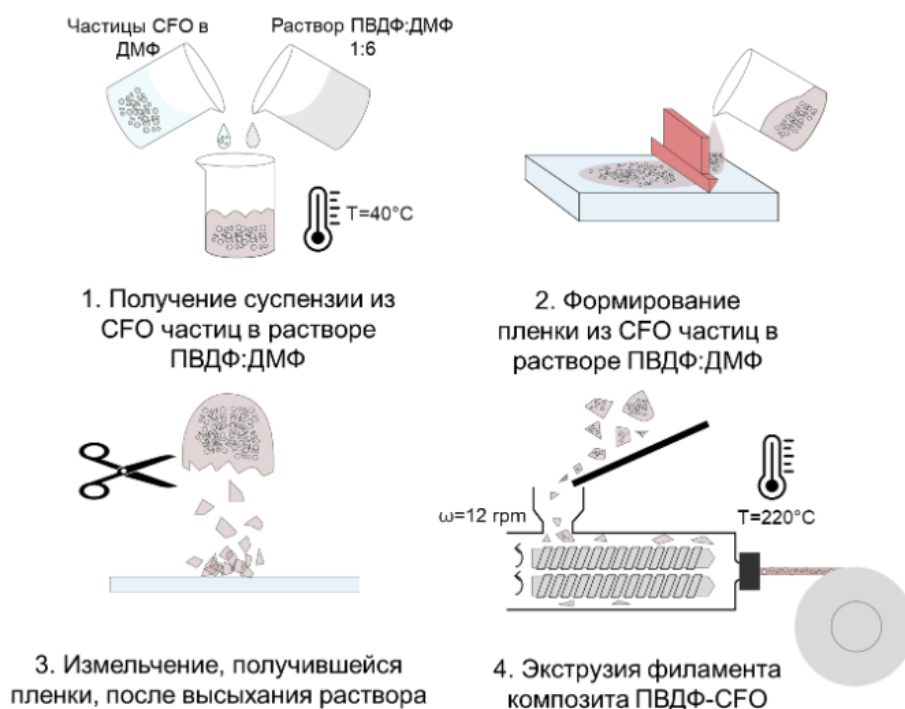
Рисунок 9. Протокол изготовления филамента ПВДФ/CoFe 2 O 4 методом послойного наложения.
