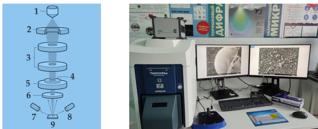
Рисунок 10. Схематическое изображение вакуумной камеры СЭМ микроскопа (здесь 1 – катод, 2 – анод, 3 – конденсорные линзы, 4 – система позиционирования пучка, 5 – объектная линза, 6 – детектор BSE электронов, 7 – детектор рентгеновского излучения, 8 – детектор SE электронов и 9 – образец) (слева), (б) фотография СЭМ микроскопа (справа).
