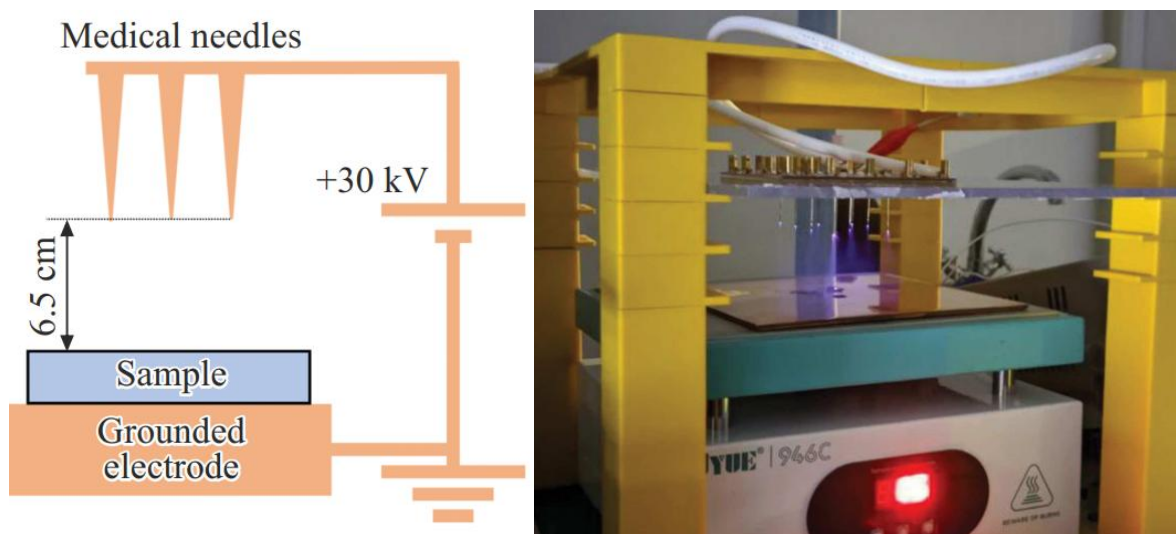
Рисунок 6. Схематическое изображение (слева) и фотография (справа) установки для поляризации пленок ПВДФ/ \text{CoFe}_2\text{O}_4 методом коронного разряда [62].
