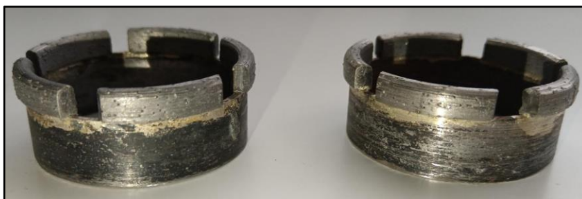
Рисунок 5.11 – Алмазные кольцевые сверла со связками (\text{CoCrFeNi})_{96}\text{Ti}_4^{\text{II}} + 2 % ПКМ (слева) и (\text{CoCrFeNi})_{96}\text{Ti}_4^{\text{C}} + 4 % ПКМ (справа) после испытаний
