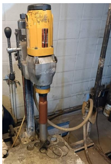
Рисунок 2.3 – Кольцевое алмазное сверло, установленное на алмазной сверлильной установке DR400A, и плита из армированного бетона
