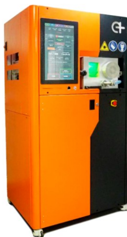
Рисунок 19 – Установка селективного лазерного плавления Addsol D50
