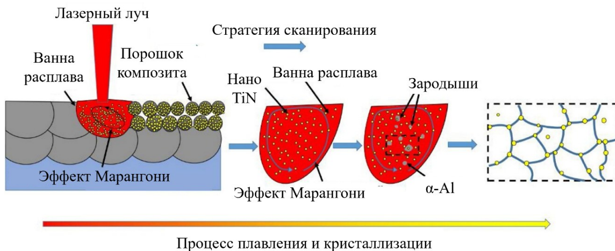
Рисунок 13 – Схематичный процесс селективного лазерного плавления АКМ в масштабе ванны расплава [77]
