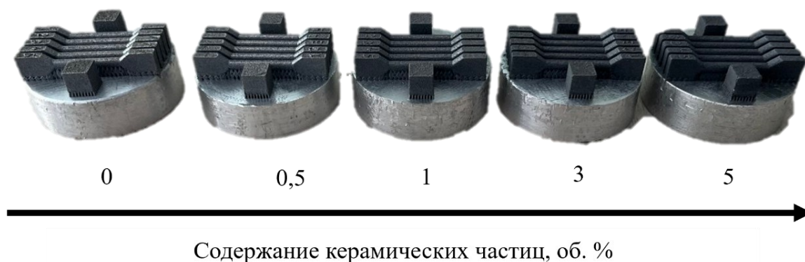
Рисунок 46 – Образцы AlSi10Mg с различной объемной долей AlN в составе (от 0,5 до 5 об. %)
