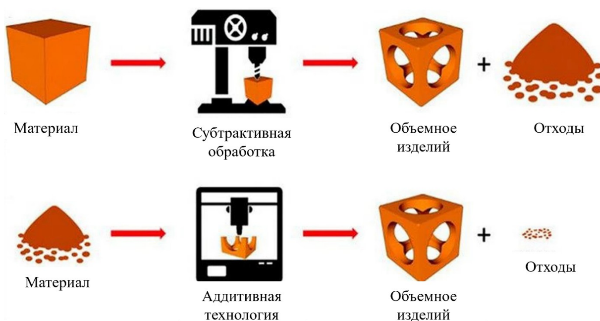
Рисунок 3 – Схемы производства субтрактивными и аддитивными методами [2]
