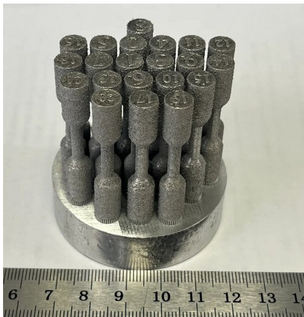
Рисунок 32 – Внешний вид образцов, изготовленных методом СЛП, для проведения одноосного растяжения
