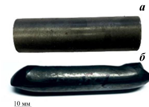
Рисунок 2.7 – Внешний вид заготовок СПФ Ti-Ni до (а) и после (б) деформации по схеме КН РКУП
