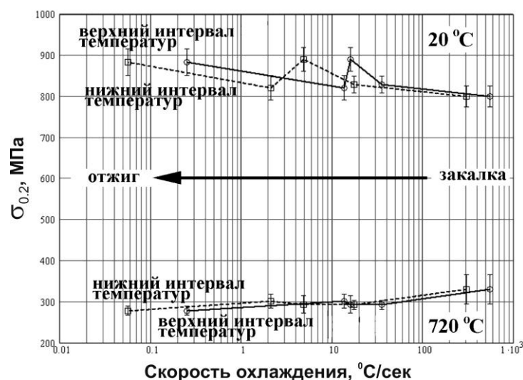
Рисунок 31 – Зависимость предела текучести стали плавки 13 при испытании на сжатие (20 °C и 720 °C) от скорости охлаждения в верхнем (1150-700 °C) и нижнем (600-300 °C) диапазоне температур. Образцы на механические испытания прошли дополнительный отпуск при 720 °C в среде аргона в течение 2 ч с последующим охлаждением на воздухе.
