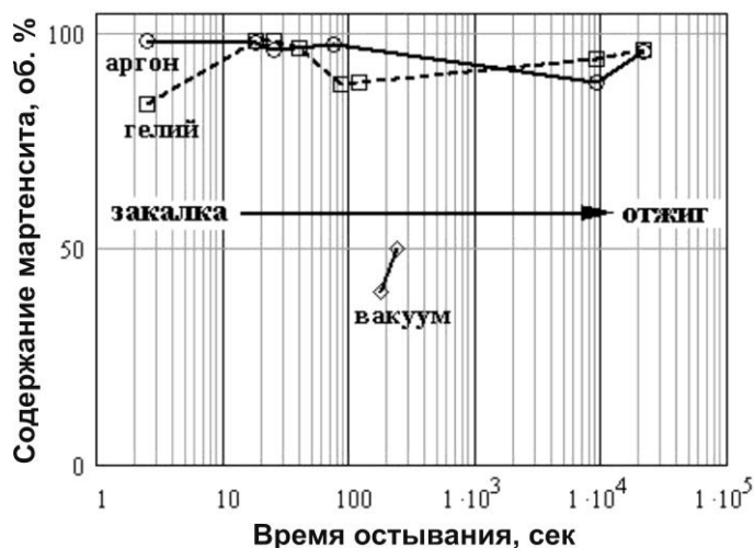
Рисунок 17 – Влияние среды (гелий, аргон, вакуум), в которой проводится нагрев под «закалку» и последующая выдержка при отпуске (720 °С, 2 ч), на содержание мартенсита в структуре стали плавки 12
