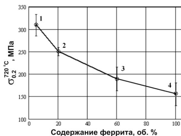
Рисунок 79 – Зависимость предела текучести при 720 °С стали с неизменным химическим составом плавки 13 мартенситного класса (95 % мартенсита) от содержания феррита в структуре. Цифрами на графике обозначены: 1 – стандартная термическая обработка (заковка, 1100 °С + отпуск 720 °С, 2 ч); 2, 3, 4 – изотермическая заковка при 700 °С в течение 200 ч, 350 ч и 450 ч.
