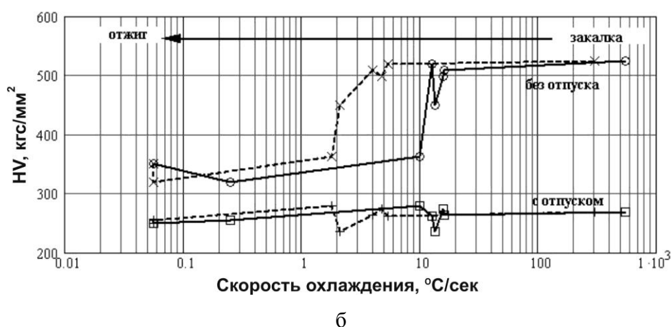
Рисунок 14 – Зависимость микротвердости образцов стали плавки 12 от характеристик охлаждения: времени интенсивного остывания при «закалке» (до момента потери светимости) (а) и скорости охлаждения (б). На рисунке а) пунктирная кривая – для образцов, прошедших отпуск при 720 °С в аргоне в течение 2 ч с последующим остыванием на воздухе; сплошная кривая – для измерений на образцах непосредственно после «закалки». На рисунке б) проанализировано влияние скоростей охлаждения в верхнем 1100-700 °С (сплошные кривые) и нижнем 600-300 °С (пунктирные кривые) интервале температур. Данные, обозначенные плюсиками и квадратами, относятся к образцам с отпуском; данные, отмеченные крестиками и кружками, получены на образцах без отпуска.
